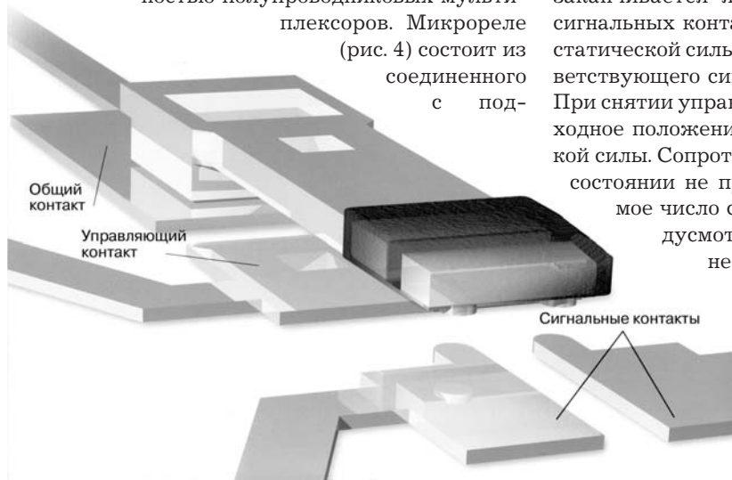
Рис. 4. Топология микрореле
