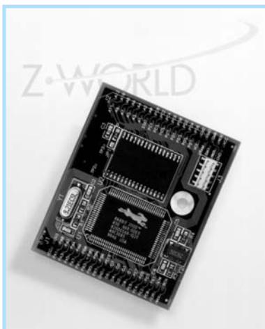
Рис. 1. Внешний вид модульного ядра Rabbit 2000
