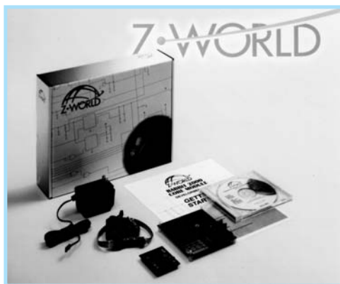
Рис. 2. Отладочный комплект для модульного ядра Rabbit 2000
