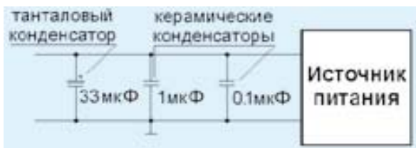
Рис. 1. Включение развязывающих конденсаторов по цепям питания для уменьшения кондуктивных помех
