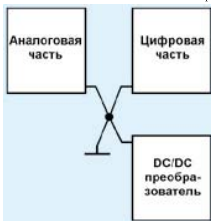
Рис. 2. Соединение общего провода различных частей схемы для минимизации помех
