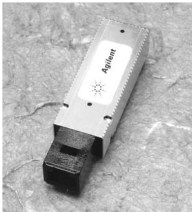
Рис. 1. Модуль приемопередатчика HFBR-5903
